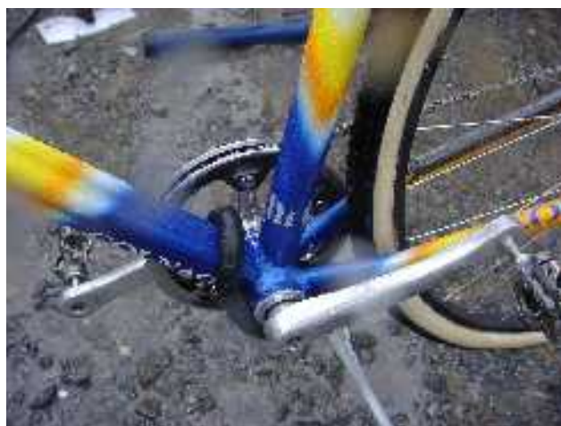
後ろブリッジは省略し泥の通りをよくする。 いずれも 34mm チューブラーがぶつからずに 装着できること。写真 いずれも柳川雅夫
